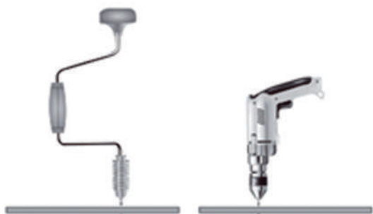
Furação de placas cimentícias com broca manual ou furadeira
