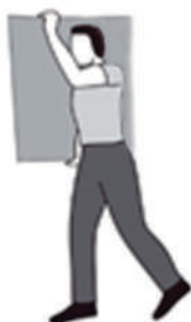
Transporte das placas cimentícias na vertical, por uma pessoa
