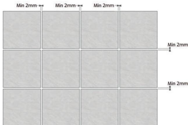
Vista superior do piso, com junta mínima de 2mm, para uso em áreas externas
