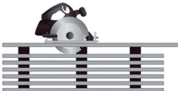
Cortes de placas cimentícias com uso de serra circular.
